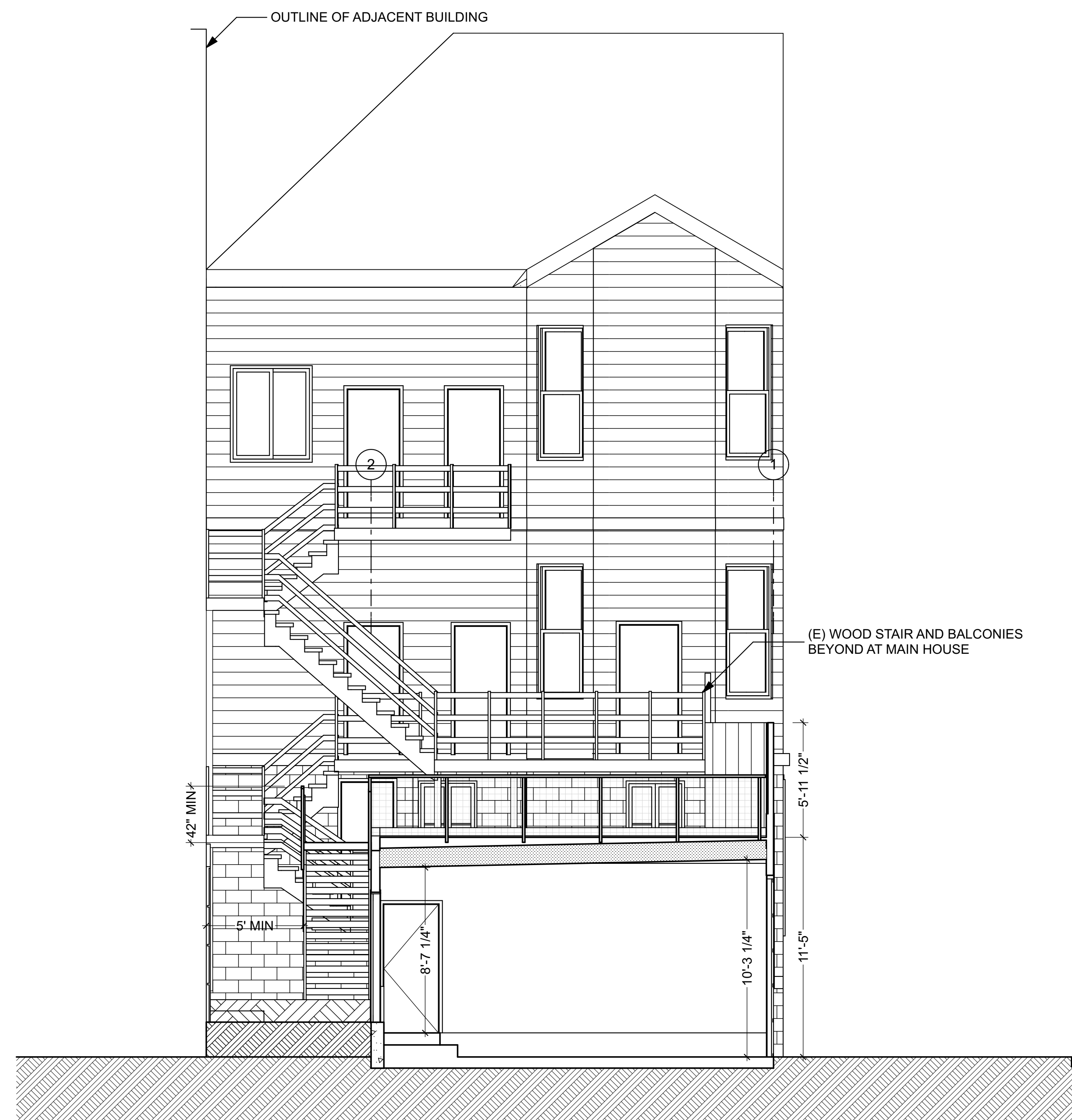
3 LONG SECTION SCALE: 1/4" = 1'-0"
